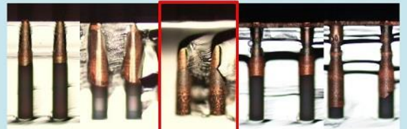
スパッタ Cu/Ti 130 μm 無電解 Cuめっき 150 μm 無電解 Ni-Pめっき 290 μm 無電解 Ni-Bめっき 140 μm 無電解 Co-Bめっき 230 μm
